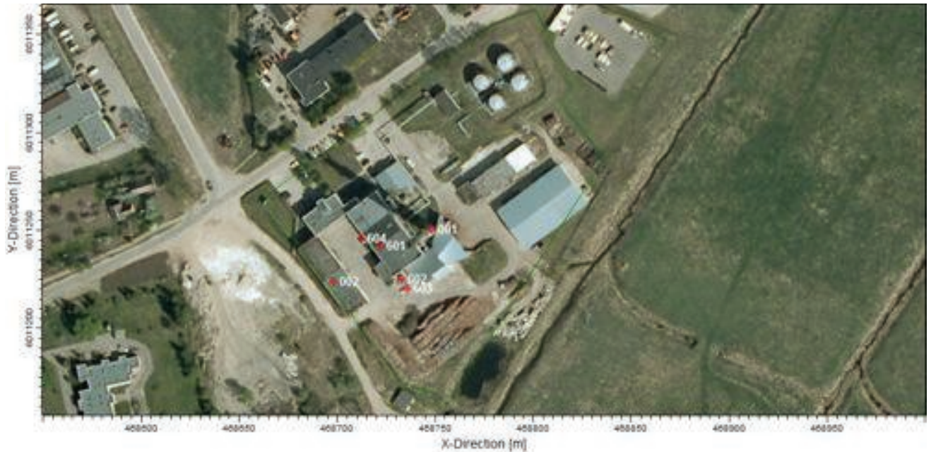
2 pav. Stacionarių aplinkos oro taršos šaltinių schema
